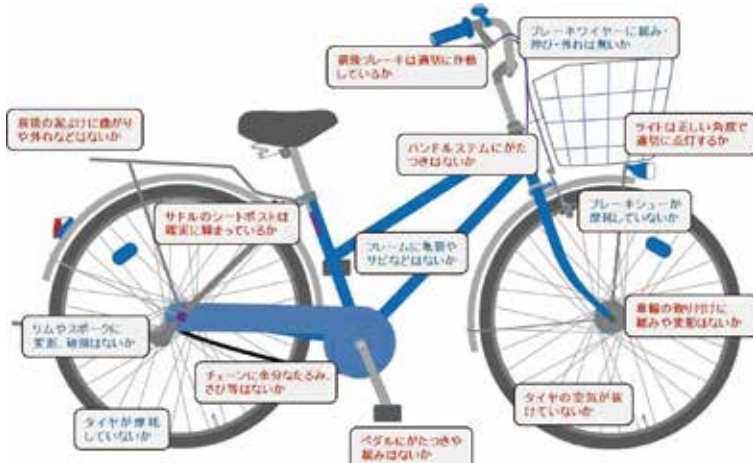
図 自転車の確認項目（赤字：乗車前確認、青字：定期点検）
